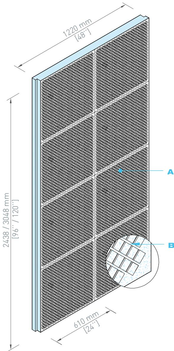
Les panneaux d'isolants rigides **SR.Drain™** fabriqués par Styro Rail™ sont composés de polystyrène expansé [PSE] type 2 [série 200] ou type 3 [séries 300 à 600]. Ils comportent une surface lisse et une surface munie de rainures en losange permettant à l'eau de s'écouler vers le bas du panneau.
