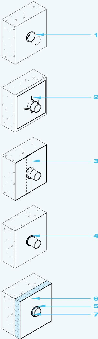
**1** Percer les ouvertures à l'aide d'une perceuse à béton et d'une mèche de dimension appropriée. Installer les conduits avant l'installation de la membrane d'étanchéité.
