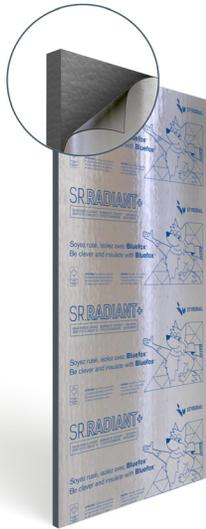
Les panneaux d'isolants rigides **SR.Radiant™+** fabriqués par Styro Rail™ sont composés de polystyrène expansé [PSE] type 1 avec graphite [Neopor® par BASF], combiné à une membrane réfléchissante pare-vapeur ayant un taux de réflectivité de 83%.
