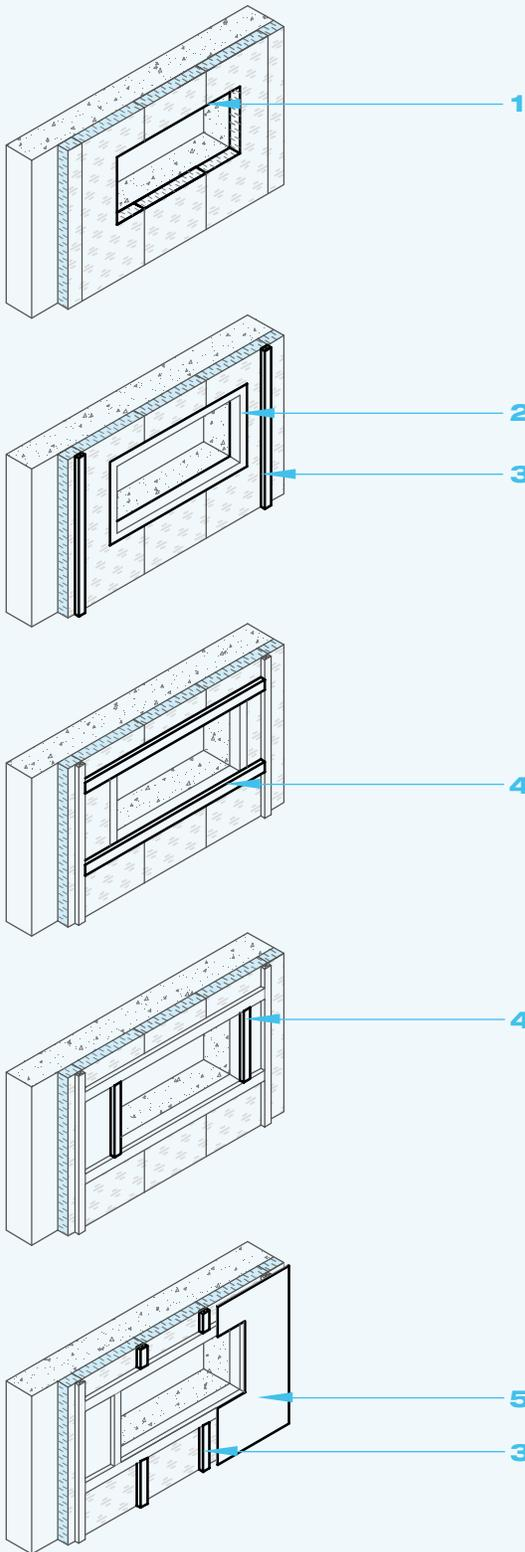
**1** Couper les panneaux pour les ajuster aux dimensions brutes des portes et des fenêtres avant l'installation de celles-ci. Couper les panneaux à effleurement avec l'ouverture brute.
