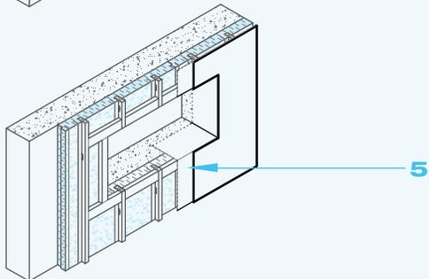
**1** Couper les panneaux pour les ajuster aux dimensions brutes des portes et des fenêtres avant l'installation de celles-ci. Couper les panneaux à effleurement avec l'ouverture brute.
