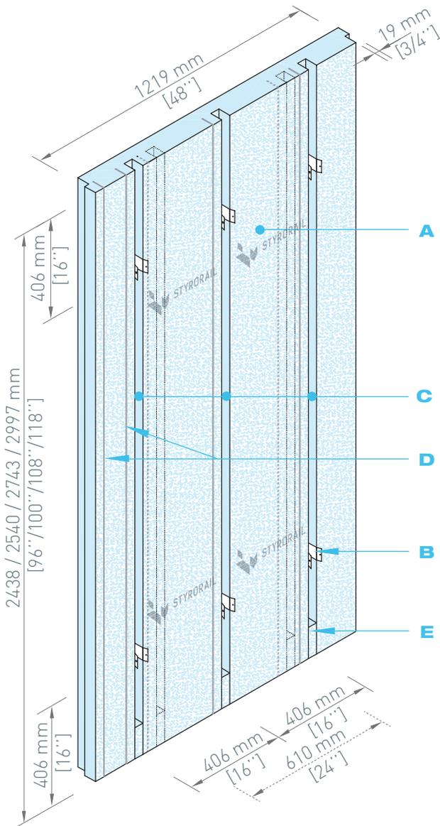
Les panneaux d'isolants rigides **SR.2X4™** fabriqués par Styro Rail™ offrent une alternative à l'isolation traditionnelle des sous-sols. Ils sont composés de polystyrène expansé [PSE] type 1. Chaque panneau comporte des rainures aux 406 mm [16''] c/c ou aux 610 mm [24''] c/c pour faciliter l'insertion des colombages de bois. Des clips de fixation métalliques sont fournies afin de fixer solidement les montants de bois au mur de béton.
