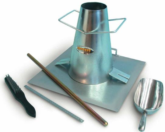
Cône d'affaissement du béton
