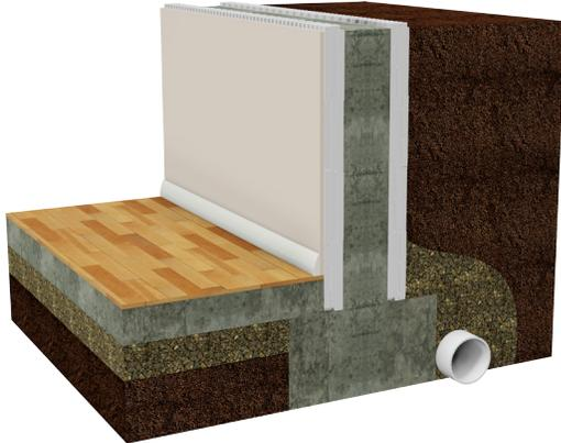
Illustration 6.1.1 Semelles standards coulées avec PVC rainuré et gravier drainant de façon naturelle ou avec une pompe de puisard.
