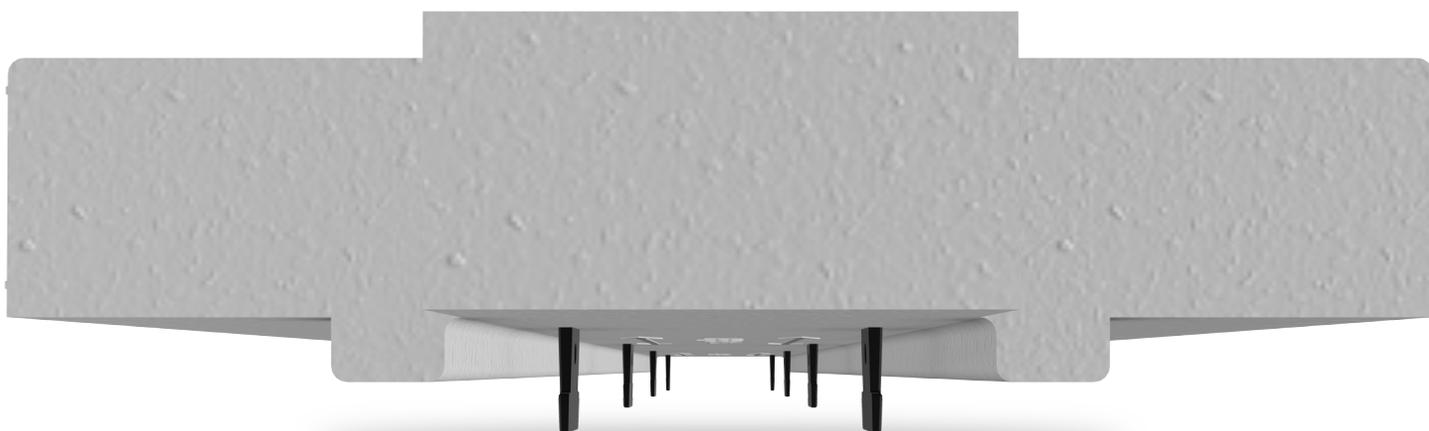
Illustration 1.3.11 Cadre BuildBuck montrant la connexion d'extrémité et les ancrages à béton en «T».
